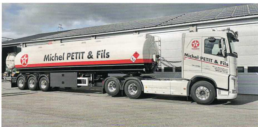
La semi-remorque de 50 tonnes est équipée du ralentisseur intégré VEB+ et du ralentisseur Voith VR3250 qui lui permettent de descendre à pleine charge de fortes pentes sans toucher les freins.
